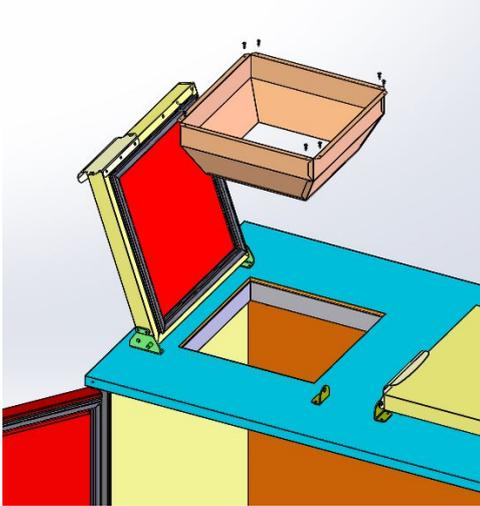
Halten Sie den Einfülltrichter für 120 L Tonnen (Artikelnummer 0075100500) sowie die beiliegenden Blechtreibschrauben bereit.
