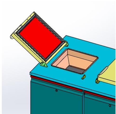
Den Trichter mit den Blechtreibschrauben und einem Schraubendreher am Abfallkühler befestigen.
