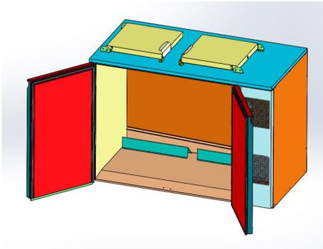
Befestigen Sie den Anfahrerschutz innen auf dem Boden (nicht an der Rückwand!!!) mit den mitgelieferten Blechtreiberschrauben.
