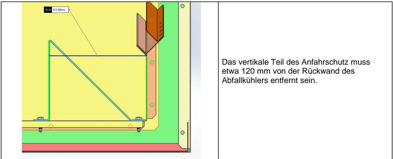
Das vertikale Teil des Anfahrerschutz muss etwa 120 mm von der Rückwand des Abfallkühlers entfernt sein.
