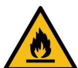
**ISO7010 W021 Apparecchiatura contenente gas infiammabile R290**
